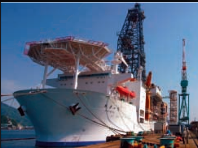
Abb. 1: Das neue 210 m lange und 38 m breite Flaggschiff des IODP: Die «Chikyu» wird fähig sein, in Wassertiefen von über 4 km bis zu 8 km unter den Meeresboden zu bohren. Der Bohrturm erhebt sich 120 m über der Wasserlinie. Das Schiff wird 150 Personen an Bord haben, davon 50 Wissenschaftler. Die Helikopterplattform überragt die Brücke am Bug des Schiffes (Foto: Ian Jarvis, Kingston University).
