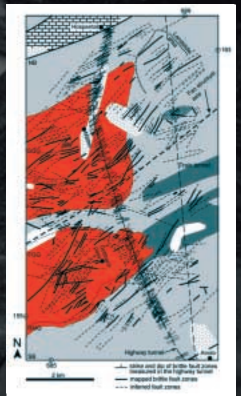
Abb. 2: An der Oberfläche und im Gotthard-Strassentunnel kartierte Störzonen zwischen Hospental und Airolo (aus Dissertation C. Zangerl, ETH 2003).
