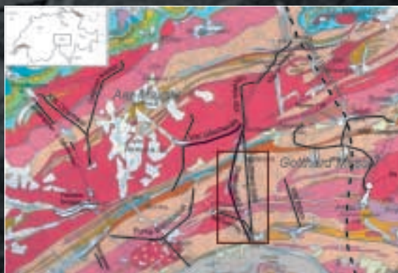
Abb. 1: Geologische Karte mit Verlauf des mittleren Abschnitts des Gotthard-Basistunnels (gestrichelt), bestehender Tunnelbauwerke und Wasserkraftstollen im Gebiet des zentralen Aar- und Gotthard-Massivs (rote Farbtöne). Das braune Rechteck stellt das Gebiet der Abbildung 2 dar.
