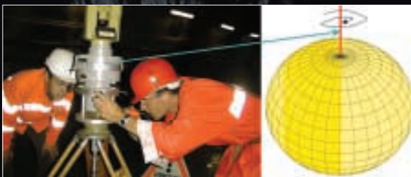
Abb. 1: Vermessungskreisel der ETHZ. Die Erde verhält sich aufgrund der Rotation wie ein Kreisel und ist aufgrund der Fliehkraft abgeplattet. Da die Rotationsachse der Erde rund 66,5^\circ gegen die Ebene der Ekliptik geneigt ist, verursacht die Anziehung von Sonne und Mond ein Drehmoment, das die Erdachse aufzurichten versucht. Dieses führt ebenso zu den kreiseltypischen Achsbewegungen der Präzession und Nutation. Zusätzliche Effekte entstehen durch Verlagerung von Massen im Erdinneren. Die Bewegung der Rotationsachse der Erde wird als Polbewegung mit hochgenauen Verfahren wie z.B. der Very Long Baseline Interferometry beobachtet. Die Bewegungen haben für die Präzession eine Periodizität von 25 600 Jahren und für die Nutation von 18,6 Jahren. Die momentane Abweichung der Erdachse von der idealen Achse wird natürlich bei den Kreismessungen im Gotthard mitberücksichtigt.
