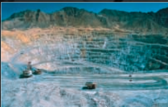
Abb. 3: Tagebau in der Kupfer-Gold-Lagerstätte Bajo de la Alumbrera, argentinische Anden. Täglich werden rund 100 000 Tonnen Erz abgebaut, was nach der Aufbereitung rund 500 Tonnen Kupfer und 60 Kilogramm Gold ergibt. Der elektrisch betriebene Bagger fasst um die 50 Tonnen Erz pro Schaufelladung; die Lastwagen haben eine Nutzlast von 250 Tonnen! Die Erzreserven in Bajo de la Alumbrera werden auf 3 300 000 Tonnen Kupfer und 380 Tonnen Gold geschätzt.
